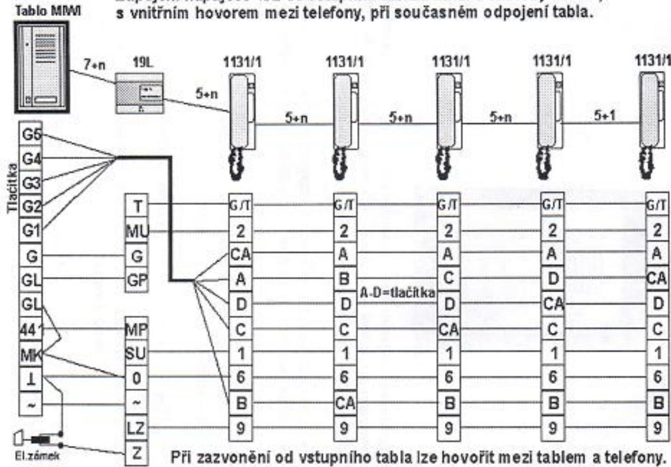
Zapojení 2 vstupních tabel MIWI pomocí přepínače P2U, s napáječem 19L
